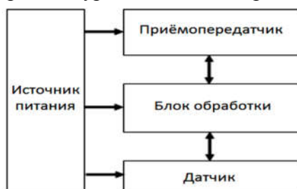
Рис.1. Аппаратная архитектура сенсорного узла
