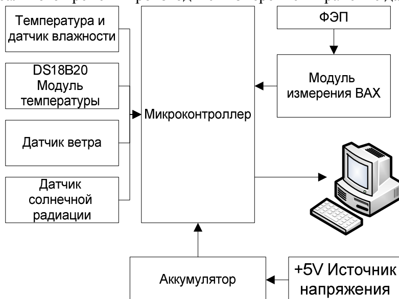
Рис. 2. Принципиальная схема взаимодействия датчиков с микроконтроллером измерительного устройства
